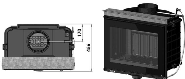
S2: Section minimum des sorties d'air de convection: 700 cm<sup>2</sup>
