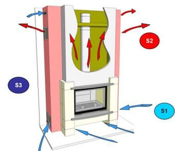
S3:Section de l'entrée d'air de combustion 100 cm<sup>2</sup>
