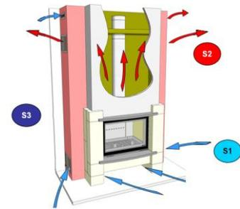
S3: Section de l'entrée d'air de combustion 200 cm<sup>2</sup> ou diamètre de l'entrée d'air de combustion dans le cas d'un raccordement extérieur Ø 100Ø
