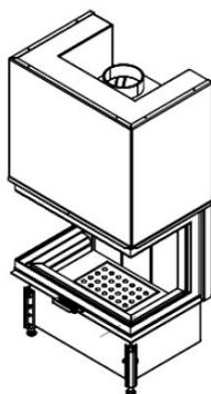
S2: Section minimum des sorties d'air de convection: 700 cm<sup>2</sup>
