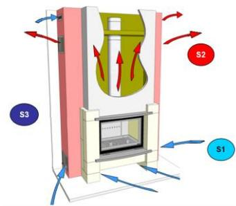
S1: Section minimum des entrées d'air de convection: 700 cm<sup>2</sup> mini
