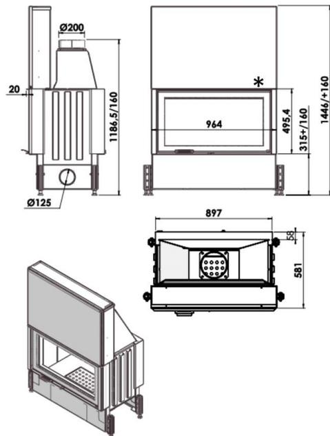
S2:Section minimum des sorties d'air de convection: 700 cm<sup>2</sup>
